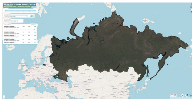
Рис. 2. Интерфейс доступа к бесшовному сплошному покрытию на основе данных с КА типа «Канопус-В», синтез каналов PAN и MS, разрешение 3 м, территория РФ
