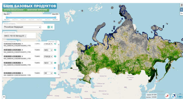
Рис. 7. Интерфейс доступа к бесшовному сплошному покрытию на основе данных с КА типа «Метеор-М», аппарата KMCC-100, продукт NDVI, разрешение 60 м, территория РФ
