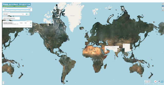
Рис. 5. Интерфейс доступа к бесшовному сплошному покрытию на основе данных с КА типа «Метеор-М», аппарата KMCC-100, красный-зеленый-синий, разрешение 60 м, весь мир
