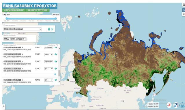
Рис. 8. Интерфейс доступа к бесшовному сплошному покрытию на основе данных с КА типа «Метеор-М», аппарата KMCC-100, продукт SR, разрешение 60 м, территория РФ
