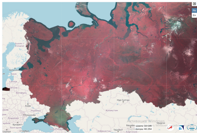
Рис. 4. Бесшовное сплошное покрытие на основе данных с КА типа «Метеор-М», аппаратура КМСС-100, БИК-красный-зеленый, разрешение 60 м, территория РФ (крупный план)
